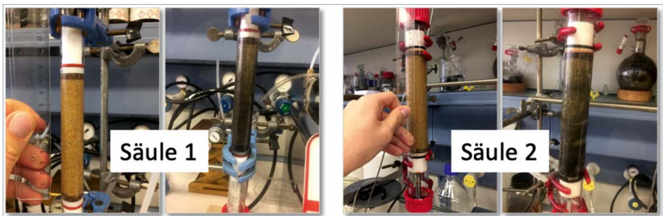
Abbildung 2: Fotos der Laborsäulen vor und nach der Einspülung von kolloidaler Aktivkohle
